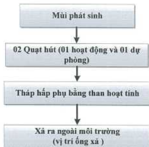
Hình 7. Sơ đồ quy trình xử lý mùi trạm xử lý nước thải
